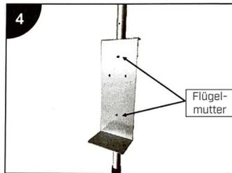
4. Platzieren Sie die Halterung an der Stange und stecken Sie die Schrauben durch den Rahmen.
