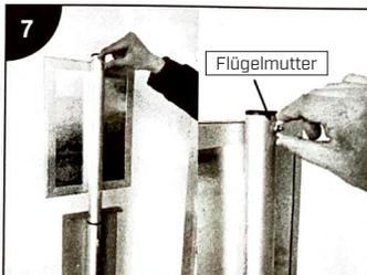
7. Befestigen Sie das Schild durch Drehen der Flügelmutter 3 auf der Rückseite des Standsystems.
