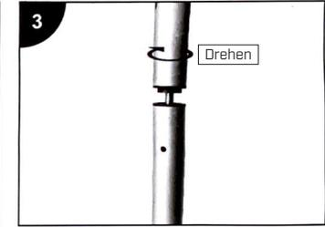
3. Optional drehen Sie auch die kurze Displaystange an den Standstange.
